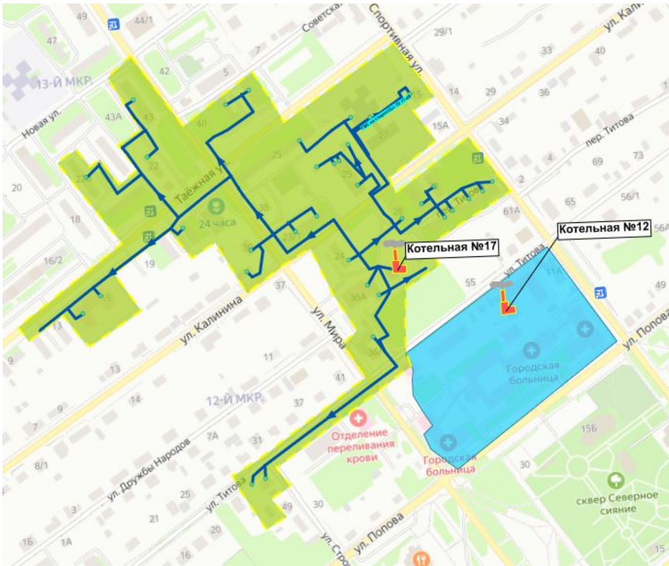
Рисунок 144. Схема трассировок сетей котельных № 17 и № 12 до переключения на котельную «Калининская» № 4
