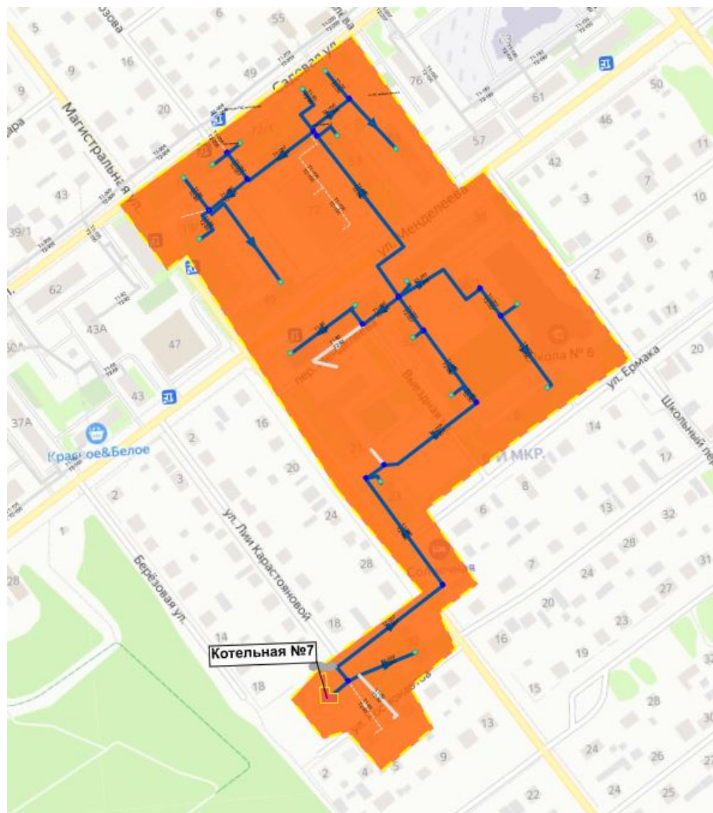
Рисунок 150. Схема трассировок сетей котельной № 7 до переключения на котельную «Финская» № 7
