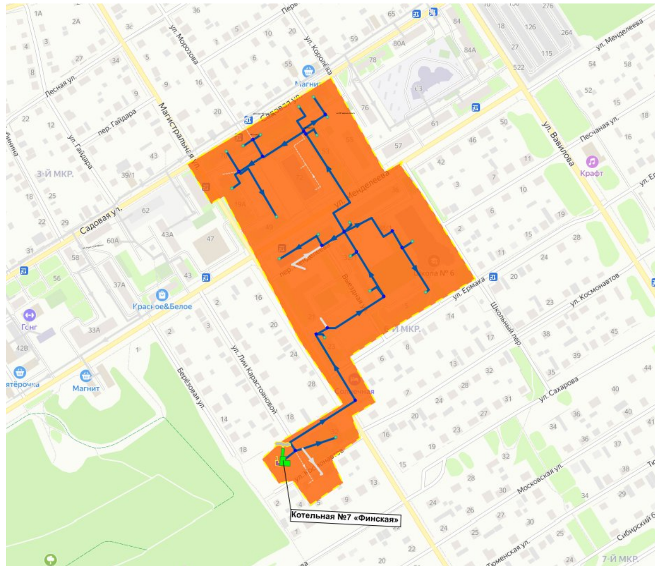
Рисунок 151. Схема трассировок сетей котельной № 7 при переключении на котельную «Финская» № 7
