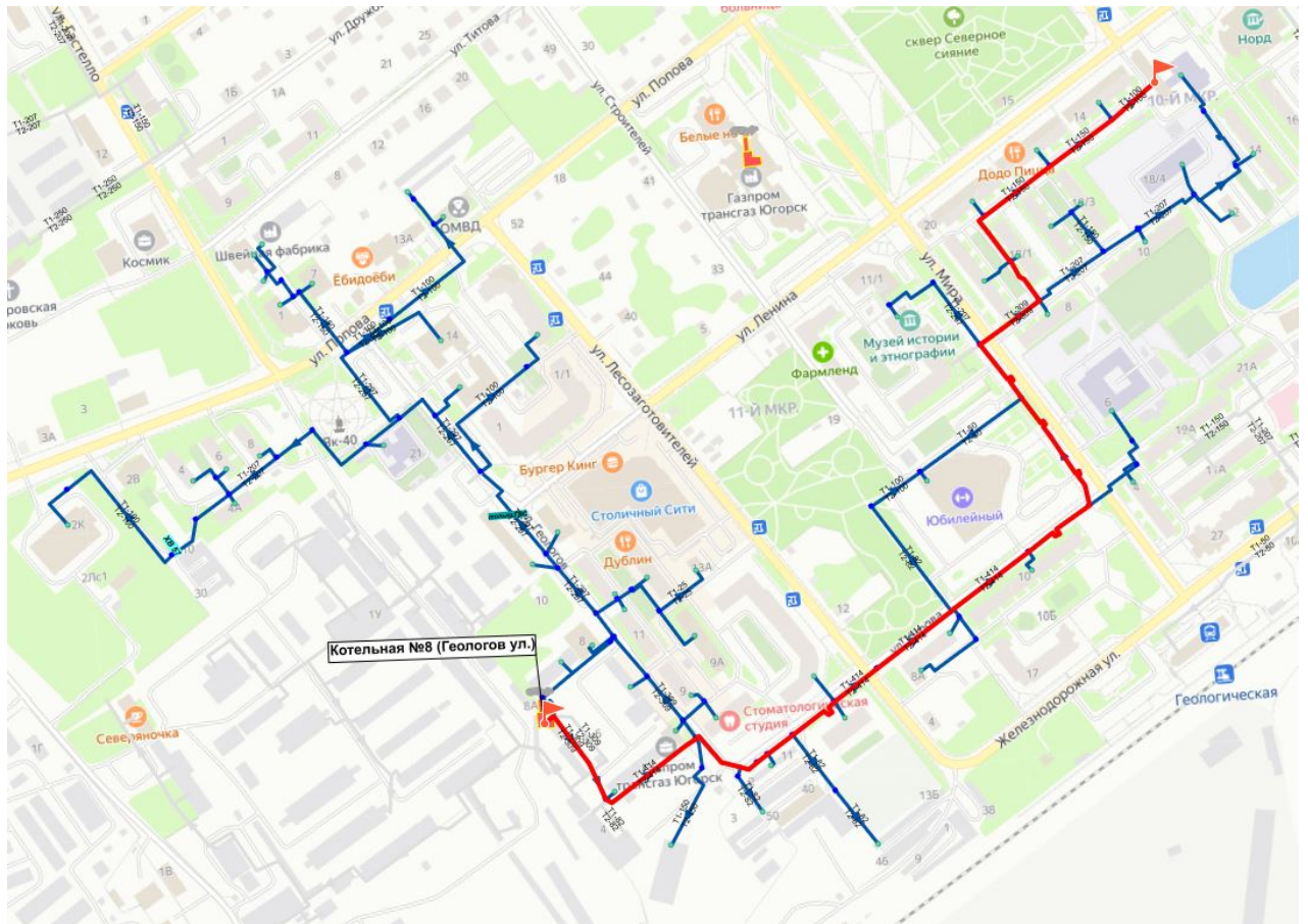
Рисунок 118. Путь построения пьезометрического графика от котельной № 8
