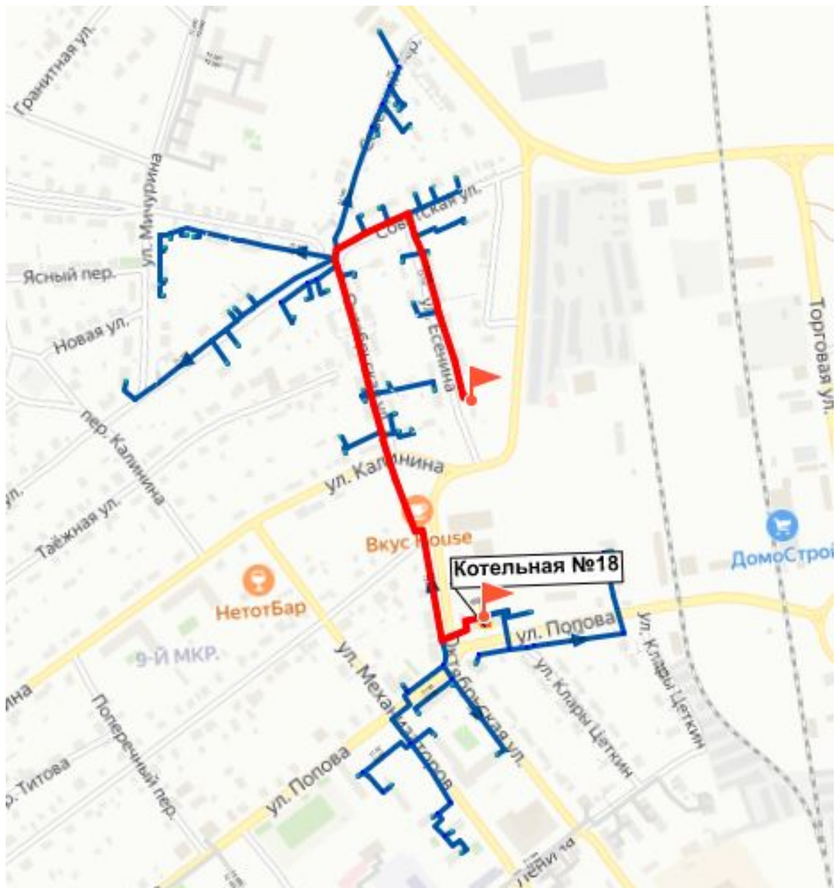
Рисунок 130. Путь построения пьезометрического графика от котельной № 18
