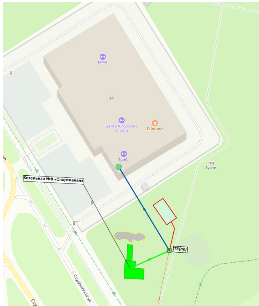
Рисунок 195. Места размещения передвижной котельной установки и точки подключения к сетям теплоснабжения в случае возникновения аварийной ситуации на источнике тепловой энергии Котельная № 8 «Спортивная»
